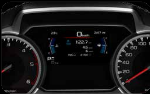
Suuri 4,2 tuuman TFT-väri näyttö: näyttää mittaristossa erilaisia auton tietoja kuljettajan mieltymysten mukaan.
