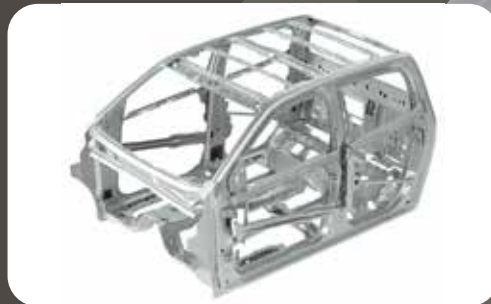
Vahvistettu ohjaamo: Ohjaamo on valmistettu korkean vetolujuuden ja jäykkyyden omaavasta suurluusteräksestä antaen näin parhaan mahdollisen suojan matkustajille.
